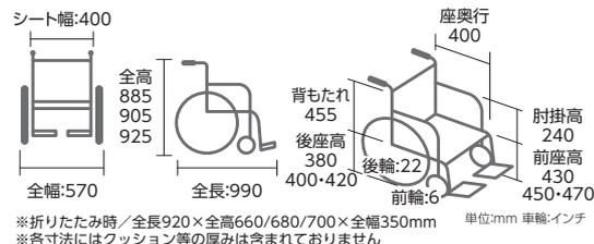
※折りたたみ時/全長920×全高660/680/700×全幅350mm 単位:mm 車輪:インチ
