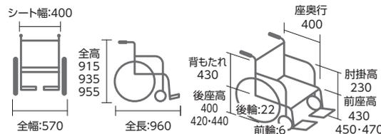
※折りたたみ時/全長940×全高640/660/680×全幅300mm 単位:mm 車輪:インチ
