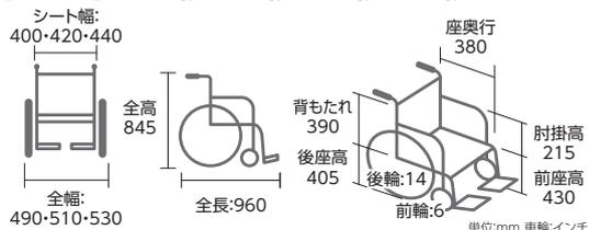
※クッション(30mm)込み寸法 ※折りたたみ時/全長840×全高670×全幅250mm
