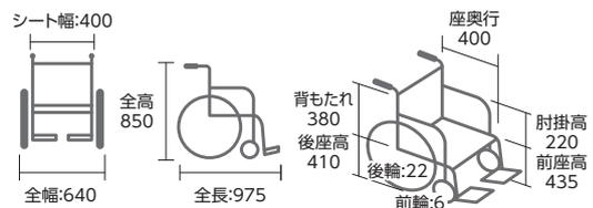
※折りたたみ時/全長950×全高660×全幅335mm 単位:mm 車輪:インチ
