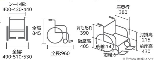
※クッション(30mm)込み寸法 ※折りたたみ時/全長600×全高670×全幅250mm
