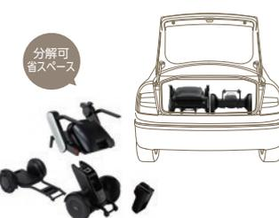
工具無しで簡単に3つのパーツに分解ができるので車載が可能に。バッテリーも取り外ししての屋内充電可。
