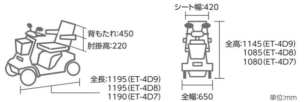
重量 100kg(バッテリー含む) 耐荷重 100kg シート幅 420mm
