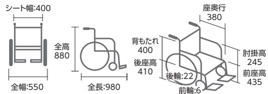
※折りたたみ時/全長930×全高705×全幅320mm 単位:mm 車輪:インチ
